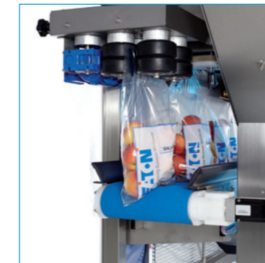
BAG SEPARATOR ABREISSVORRICHTUNG Rubber rollers | Gummirollen
